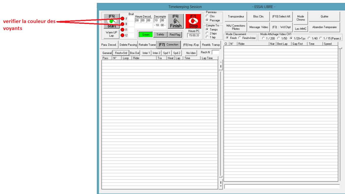
Si les deux premiers voyants sont rouges le chronométrage ne peut être lancé car il n'y a aucune liaison entre le logiciel et le décodeur.
